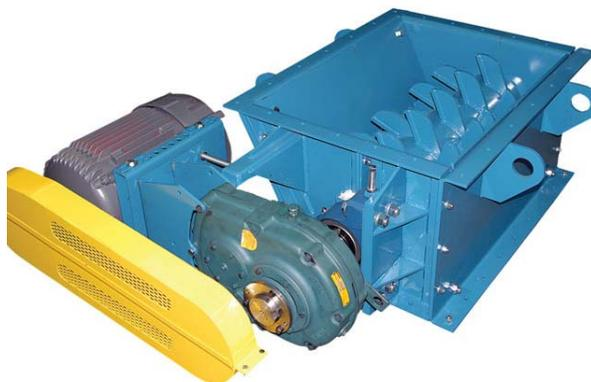
O propósito do quebrador de grumos J&H é quebrar grumos de até 400 mm em diâmetro em 25 mm ou menos de forma a preparar o material para transporte ou peneiramento enquanto utiliza uma quantidade mínima de energia. Sua capacidade chega a 800 tph ou 1500 tph em unidades de rotor duplo.
